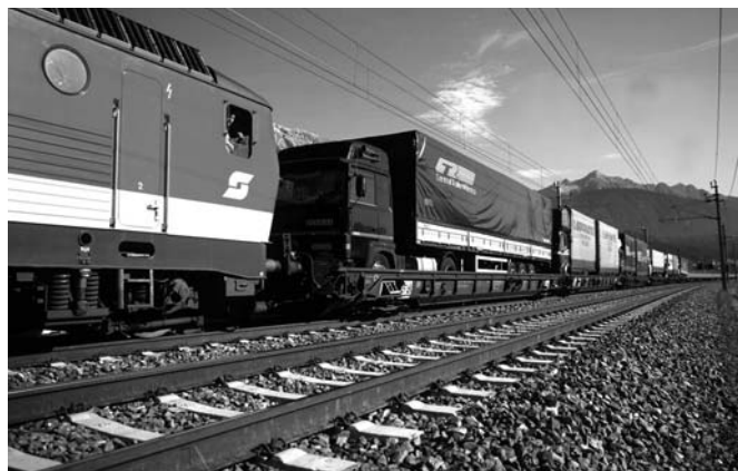
Mit „Rollender Landstraße“ wird jene Art des Güterverkehrs bezeichnet, bei dem Lkw aller Art auf speziellen Zugwägen (Niederflurwägen) mit ihren Gütern transportiert werden. Die FahrerInnen reisen in Begleitwägen mit.
