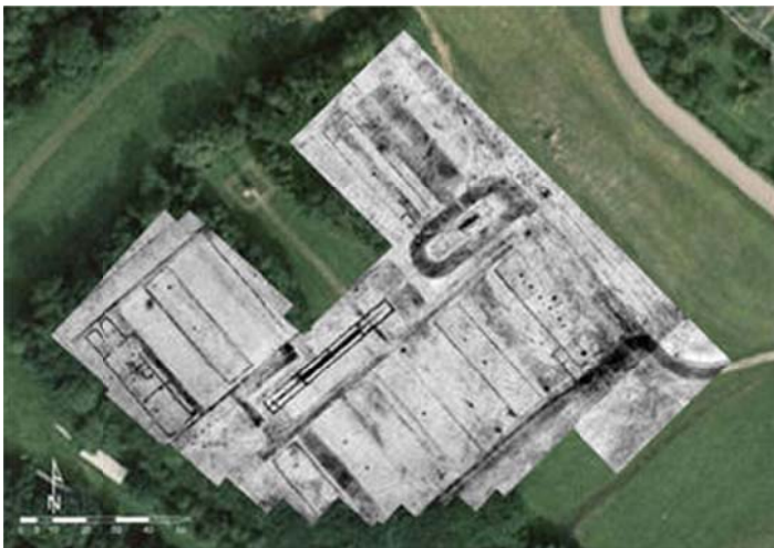
Georadarbild des Sanitätslagers. Deutlich sind die Fundamente der Baracken zu erkennen (©ArchaeoProspects)
